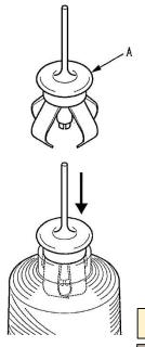
1. A セットを糸コーン上部の穴に差込み固定します。 2. 糸を B セットの内側から上に向かって通し、 B セットを A セットにかぶせます。 その後、通常通り糸を機械に通してください。
